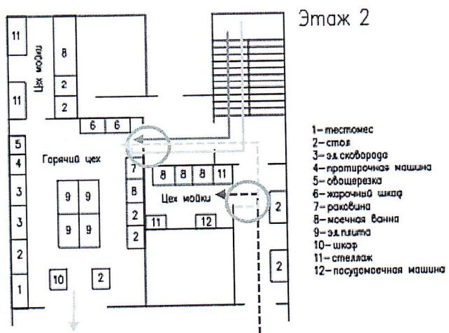
**Условные обозначения поточности технологических процессов:**
